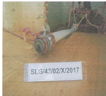
Uji Pecah ( Burst Test )
